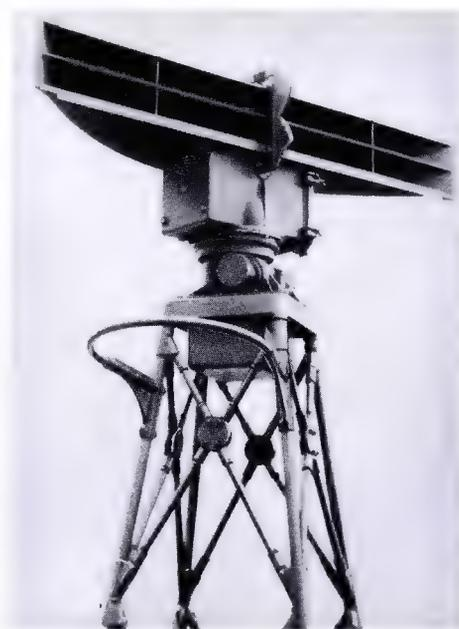
Antenne und Hf-Einheit der Kurs-Radaranlage TM 46
